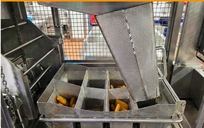
S1000 : Répartition par trémie articulée et dépose avec masque monte/baisse
