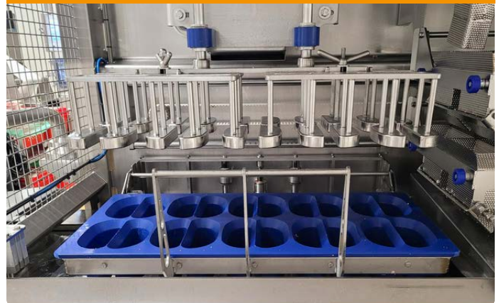
S3600 : Répartition haute performance par trémie articulée et transfert de doses
